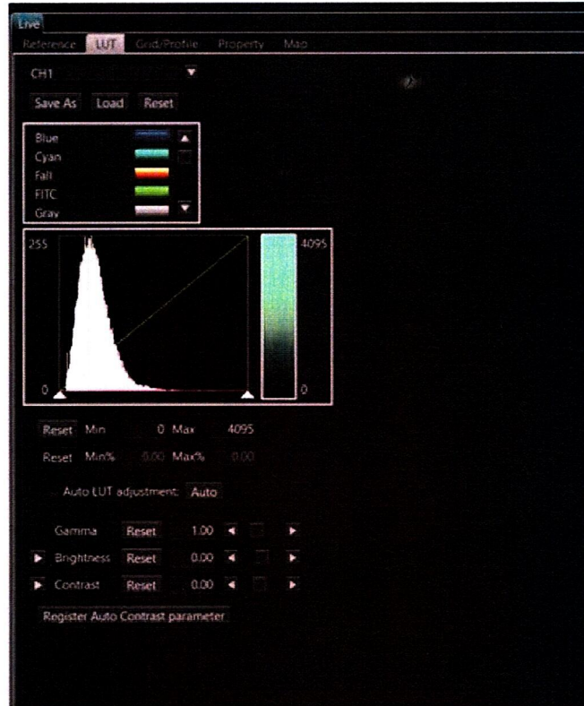
ภาพที่ 13 แสดงการเปลี่ยนสี Psuedo Color ของแต่ละ Channel
